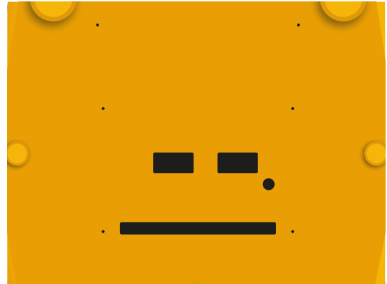
Decke mit Bohrlöchern und Ausschnitten für die Installation von Integral Power II
